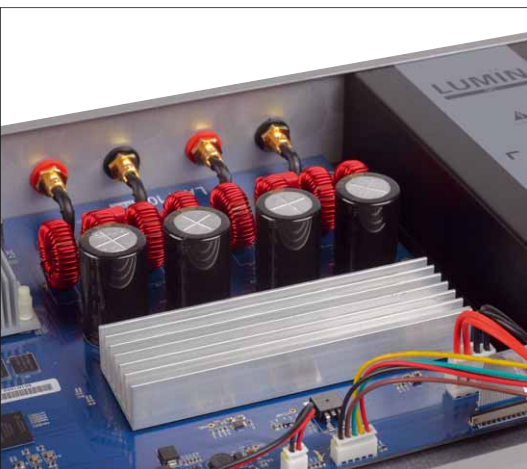
Erst bei den Endstufen wird das digitale Signal endlich in ein analoges umgesetzt
