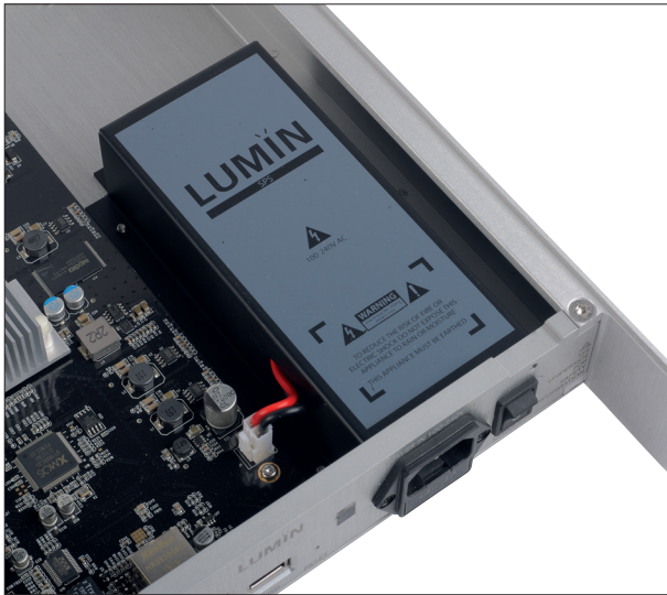
Anstelle des linearen Netzteils aus dem X1 kommt hier ein Schaltnetzteil zum Einsatz
