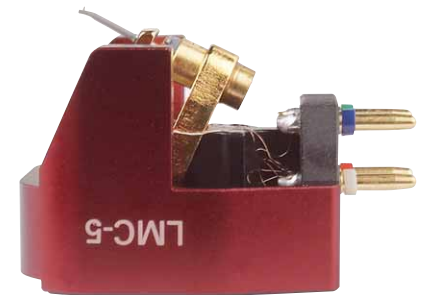
Der Hersteller setzt auf einen Nadelträger aus Aluminium
