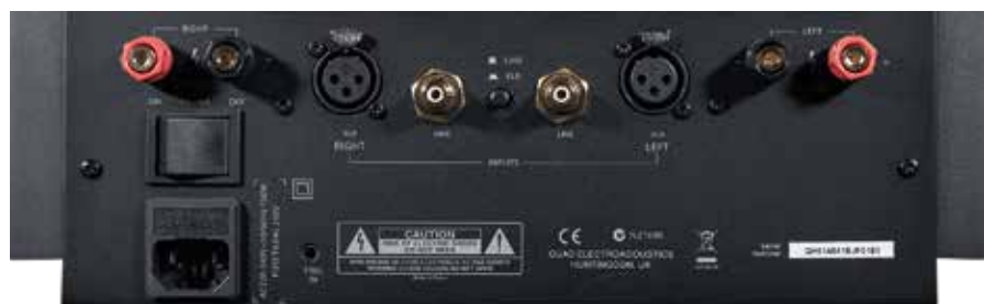
Zwischen den XLR- und den Cinch-Anschlüssen des Quad Altera Stereo befindet sich ein kleiner Schalter zur Eingangswahl
