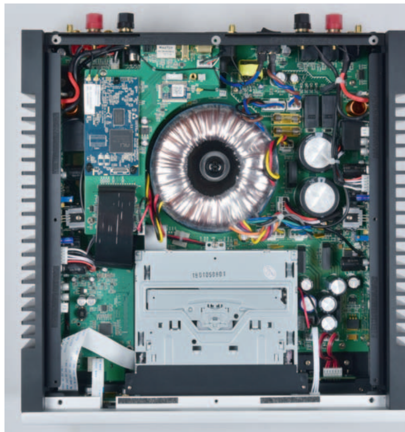
Das Machtwort im Zentrum: Ein großer Ringkerntrafo verstrickt die Stromkraft. An der Front liegt das dünne Einzugslaufwerk für CDs. Die Seitenwangen dienen als Kühlrippen für Class-A/B.
